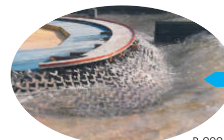
Лабораторное моделирование волновых воздействий на сооружения
